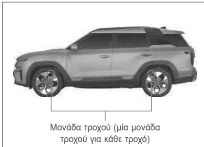
Η ηλεκτρονική μονάδα ελέγχου του TPMS λαμβάνει διάφορα δεδομένα, συμπεριλαμβανομένης της πίεσης και της θερμοκρασίας των ελαστικών, από τη μονάδα τροχού που είναι τοποθετημένη σε κάθε τροχό και εμφανίζει τα δεδομένα αυτά στον πίνακα οργάνων.
