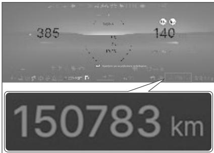
Η συνολική χιλιομετρική απόσταση του αυτοκινήτου εμφανίζεται σε χιλιόμετρα. Η μέγιστη χιλιομετρική απόσταση που μπορεί να εμφανιστεί είναι 999999 χλμ.
