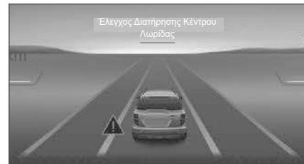
Εμφανίζει εάν η λειτουργία Υποβοήθησης Διατήρησης Λωρίδας (LKA) βρίσκεται υπό έλεγχο.
