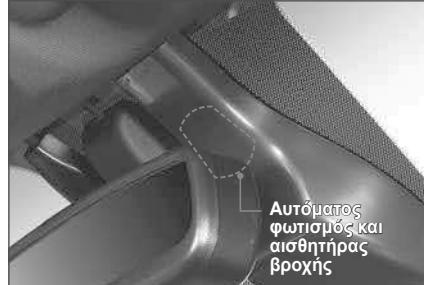
Ο αισθητήρας αυτόματου φωτός είναι ενσωματωμένος με τον αισθητήρα βροχής.
