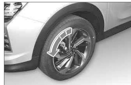
Σε περίπτωση υπερβολικής σύσφιξης, τα παξιμάδια του τροχού μπορεί να υποστούν ζημιά. Μην σφίγγετε υπερβολικά τα παξιμάδια των τροχών πιέζοντας το κλειδί για τα παξιμάδια των τροχών με το πόδι ή χρησιμοποιώντας σωλήνα υποβοήθησης.
