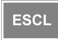
Πρόκειται για τη συσκευή που έχει τον ηλεκτρονικό έλεγχο του κλειδώματος και του ξεκλειδώματος του τιμονιού στο όχημα με το έξυπνο κλειδί. Εάν ανάψει η προειδοποιητική λυχνία ESCL, το αυτοκίνητο δεν πρέπει να τίθεται μπροστά και να οδηγηθεί. Σε αυτή την περίπτωση ζητήστε τον έλεγχο του συστήματος από Αντιπρόσωπο KGM ή Εξουσιοδοτημένο Κέντρο Εξυπηρέτησης KGM.
