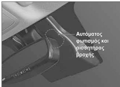
Ο αισθητήρας βροχής είναι ενσωματωμένος με τον αισθητήρα αυτόματου φωτός.
