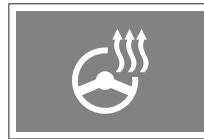
Εάν πατήσετε το κουμπί θέρμανσης του τιμονιού με τον διακόπτη START/STOP σε κατάσταση ON ή ενώ λειτουργεί ο κινητήρας, η ένδειξη του θερμαντήρα του τιμονιού ανάβει ή σβήνει.
