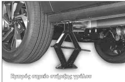
**3** Τοποθετήστε τον γρύλο ακριβώς κάτω από τα σημεία ανύψωσης, έτσι ώστε η κορυφή του γρύλου να έρχεται σε επαφή με το όχημα στο σημείο ανύψωσης.
