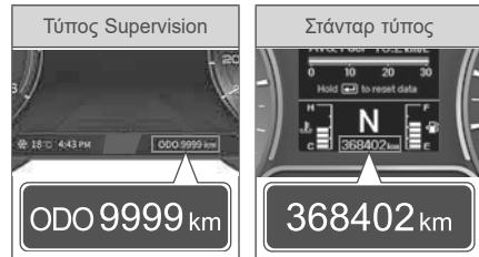
Η συνολική χιλιομετρική απόσταση του αυτοκινήτου εμφανίζεται σε χιλιόμετρα. Η μέγιστη χιλιομετρική απόσταση που μπορεί να εμφανιστεί είναι 999999 χλμ.
