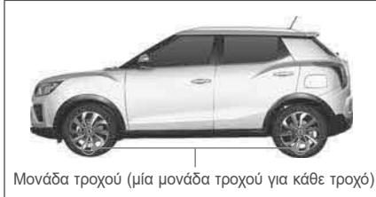
Η ηλεκτρονική μονάδα ελέγχου του TPMS λαμβάνει διάφορα δεδομένα, συμπεριλαμβανομένης της πίεσης και της θερμοκρασίας των ελαστικών, από τη μονάδα τροχού που είναι τοποθετημένη σε κάθε τροχό και εμφανίζει τα δεδομένα αυτά στον πίνακα οργάνων.
