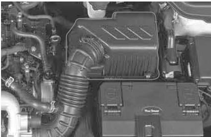
Εάν το όχημα λειτουργεί σε πολύ σκονισμένες ή αμμώδεις περιοχές, αντικαταστήστε το πιο συχνά από τα συνήθη συνιστώμενα διαστήματα. Εάν είναι βρώμικο, ανακινήστε το στοιχείο για να απομακρύνετε τη σκόνη. Καθαρίστε το εσωτερικό του περιβλήματος του φίλτρου αέρα και του καλύμματος με ένα υγρό πανί.
