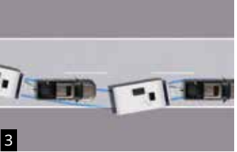
3. Σύστημα Υποβοήθησης Σταθερότητας Ρυμουλκούμενου (TSA)
