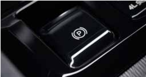
Ηλεκτρικό χειρόφρενο (EPB) με Auto Hold
