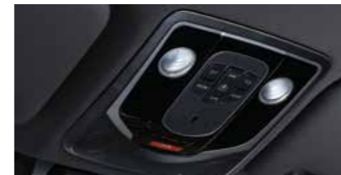
Οροφή κονσόλας με φως και διακόπτη ελέγχου ηλιοροφής
