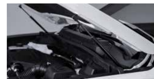
Υδραυλική υποστήριξη καπό
