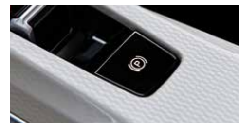
Ηλεκτρικό φρένο στάθμευσης με λειτουργία αυτόματης στάθμευσης
