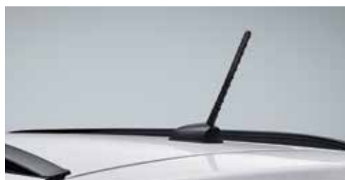
Κεραία στήλης τοποθετημένη στην οροφή
