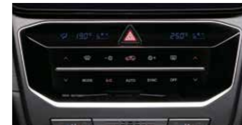
Αυτόματος 2-ζωνικός κλιματισμός
